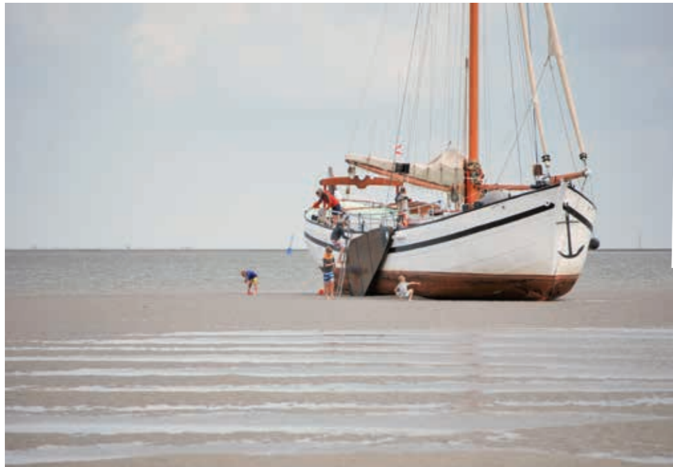
links: De Aaltje Engelina drooggevallen op het Wad. Goed te zien is dat het schip slechts 80 cm steekt
